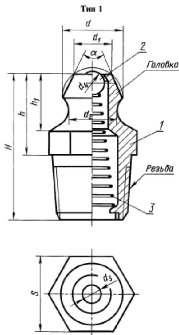
1 — корпус масленки; 2 — запорный элемент; 3 — пружина.
