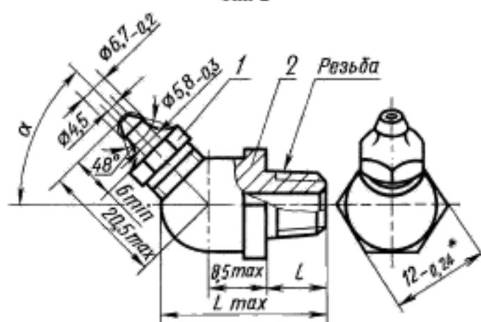
\* Допускается изготовлять размер «под ключ»  $10_{-0,2}$  мм.
