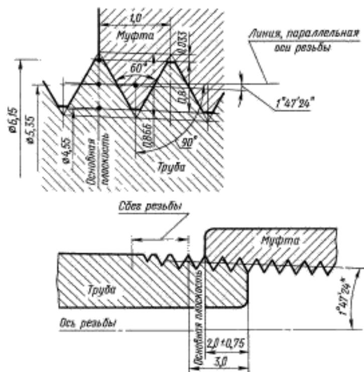
1. Шаг резьбы измеряется параллельно оси трубы.
